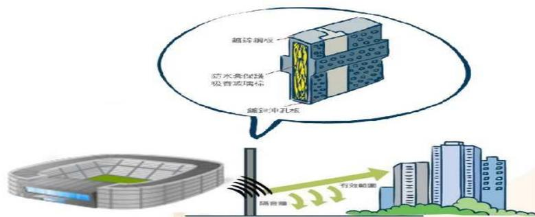
圖 9 隔音牆示意圖
