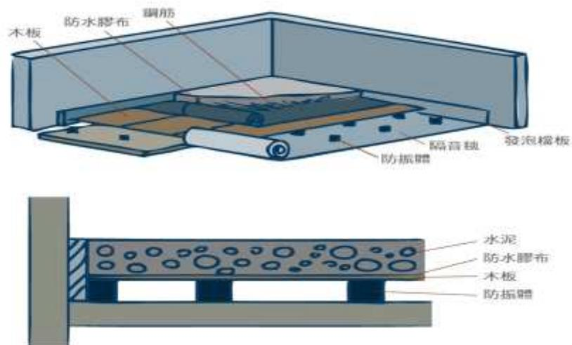
圖 5 浮式地板衝擊音的防制機制
