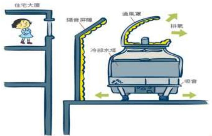
圖 6 冷卻水塔噪音防制方式
